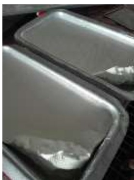
1. นำน้ำยางสดผ่านการกรองมาจับตัวด้วยกรดฟอร์มิก
