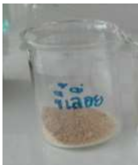
4. เตรียมซีลี้อยู่ที่ผ่านการร่อนเพื่อคัดขนาด ล้างด้วยน้ำมันสนและอบไล่ความชื้น
