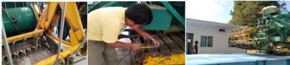
ภาพที่ 6 การวัดความสูงการตัด, การวัดมิติของแป้นล้อตีนตะขาบ และการชั่งน้ำหนักของรถเกี่ยว ตามลำดับ
