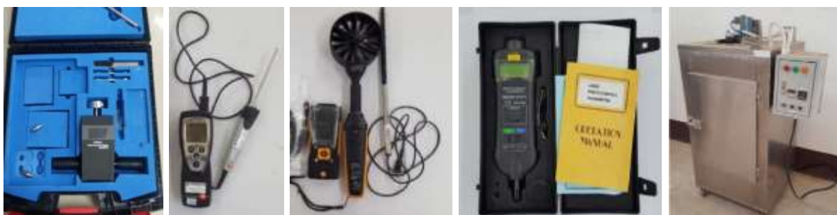
ภาพที่ 3 ตัวอย่างอุปกรณ์ที่ใช้ทดสอบ ได้แก่ เครื่องวัดแรงต้านแรงกดดิน เครื่องวัดอุณหภูมิ เครื่องวัดความเร็วลม เครื่องวัดความเร็วรอบ และ ตู้อบลมร้อน ตามลำดับ
