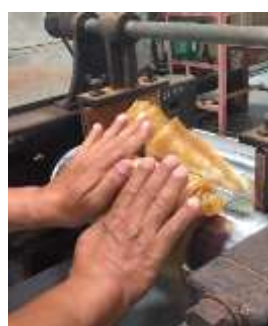
5. บดผสมยางกับซีลี้อยู่ด้วยเครื่องบดสองลูกกลิ้งให้เป็นเนื้อเดียวกัน
