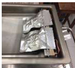
7. นำยางที่แบ่งไว้ใส่ถุงเพื่อซีลป้องกันการปนเปื้อน
