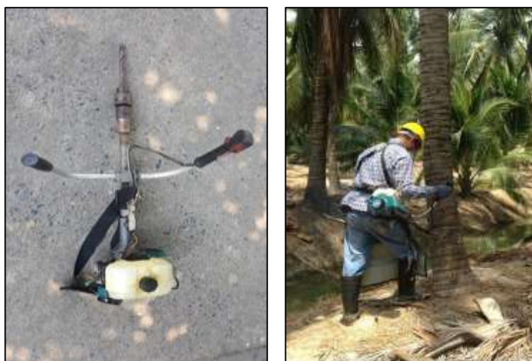
ภาพที่ 1.2 ส่วนที่ตัดแปลงจากเครื่องตัดหญ้า และวิธีการเจาะต้น
